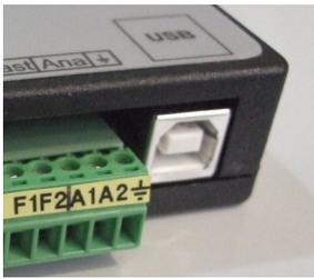
Il modulo EZ-Red si collega al computer tramite l'interfaccia USB, con un connettore standard “Type B” mostrato qui a fianco.
