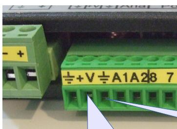
Sulla morsettiera delle uscite è disponibile una alimentazione ausiliaria di 12 volt, stabilizzata, con corrente massima di 300 mA, protetta da un fusibile auto ripristinante.
