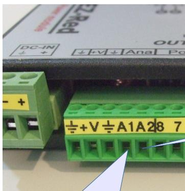
Le uscite analogiche AOUT1 e AOUT2 (A1 e A2 sulla morsettiera delle uscite) possono fornire circa 20 mA massimi, e dispongono di un circuito di protezione. La tensione analogica va da 0 a 10 volt.
