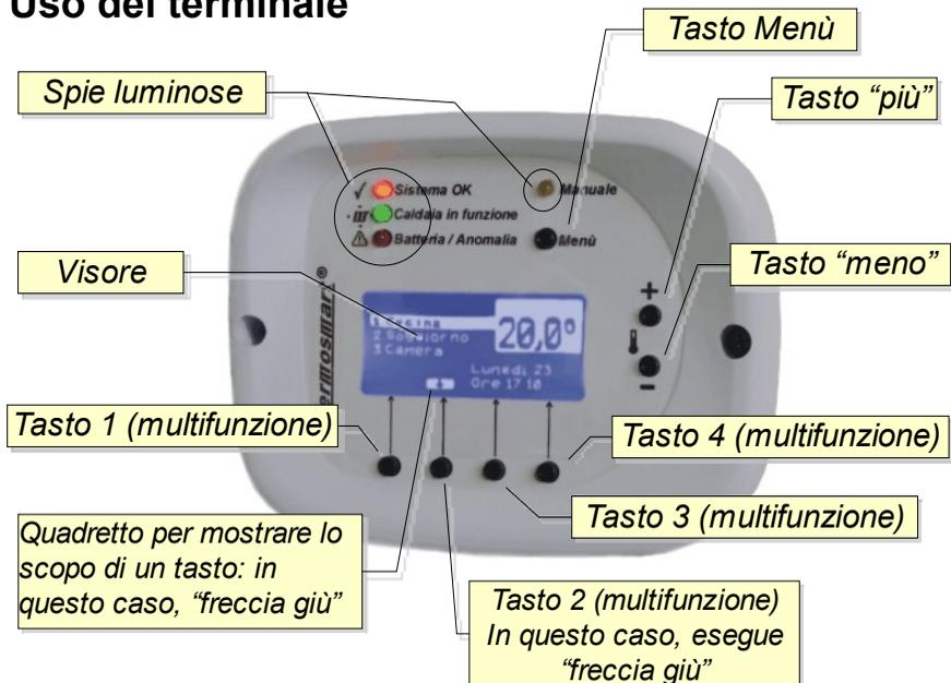
Sul terminale vi sono quattro spie che indicano lo stato generale del sistema. La spia blu "Sistema OK" indica che il Termosmart è alimentato e funziona regolarmente. Subito sotto, la spia verde "Caldaia in funzione"
